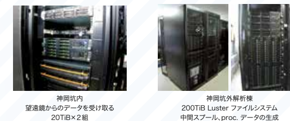
図5：KAGRAのデータ転送・保管システムのハードウェア（一部）
