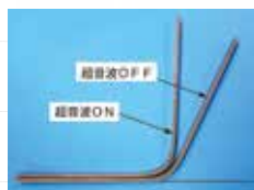
◀ 高張力鋼板に衝撃を印加した後の様子
