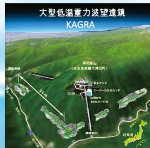
図4：中央L字型装置が大型低温重力波望遠鏡 KAGRA（かぐら）（東京大学宇宙線研究所 三代木氏提供）
