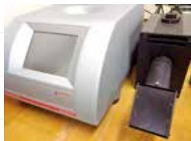
触媒調製用のマイクロ波合成装置(左)と紫外光ランプ装置(右)
