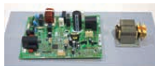
開発したインバータ基板
