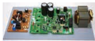
従来のインバータ基板
