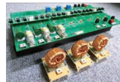
効率99%を実現するSiCマトリックスコンバータ
