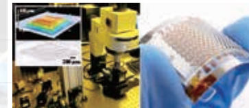
金属・半導体微細構造用3Dプリンタ（左）とレンズアレイ付フレキシブル熱電発電デバイス（右）
