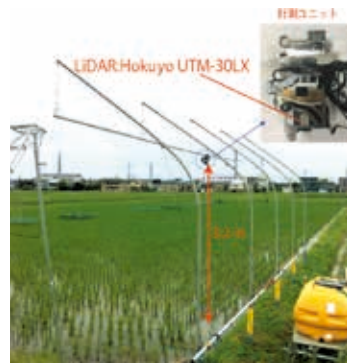
図1 水田に敷設した実験装置(レールに沿ってLiDARが移動することで水稲の点群を取得)
