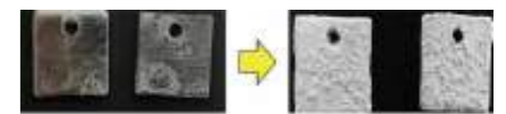
図1 亜鉛メッキ金属板を用いた腐食及びスケール生成挙動実験の様子
