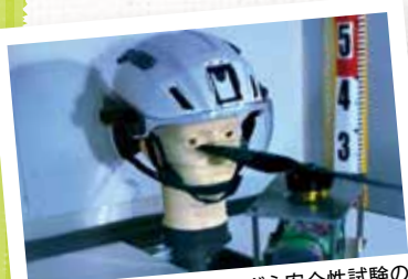
ドローンに対する保護メガネ安全性試験の様子
