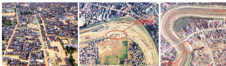
▲平成16年7月福島・新潟豪雨による a)三条市の浸水、b)五十嵐川の破堤、c)刈谷田川の破堤
