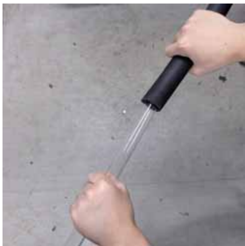
石英管をホースに接続する作業
