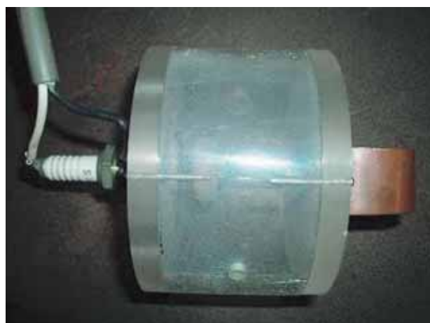
写真 4 遠隔操作放電スイッチ
