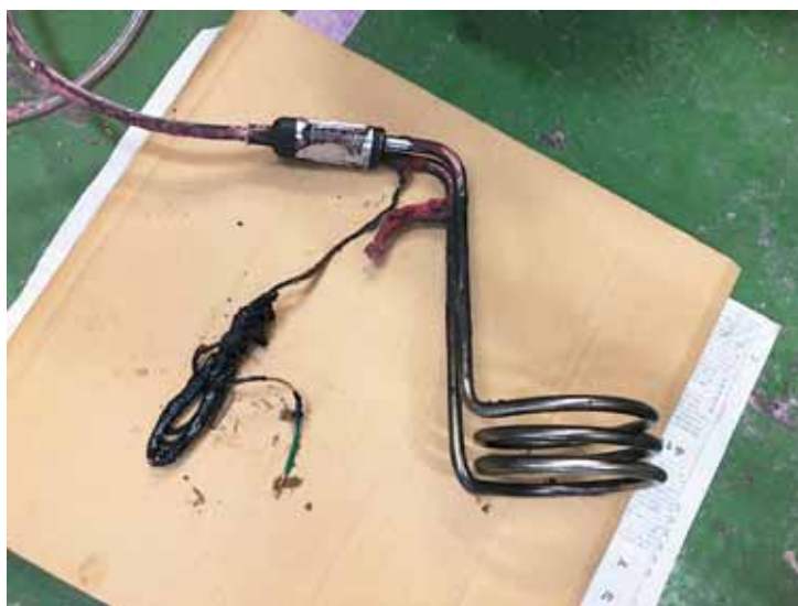
油の入った容器内に設置されていた電気ヒーター
