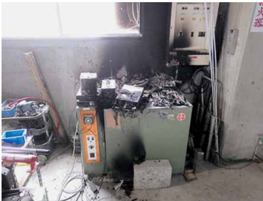
焼け焦げた乾燥炉
