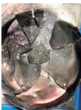
破損したオイル受部
