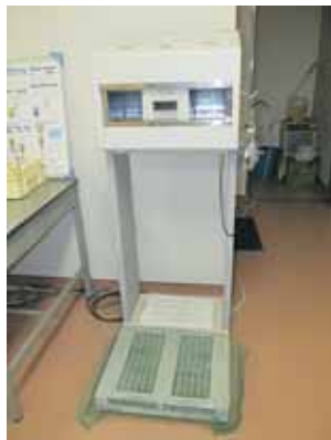
図 8-5 手足衣服の汚染検査装置(ハンドフットクロスモニタ)
