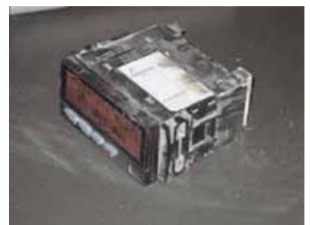
一部が焼けた電圧表示
