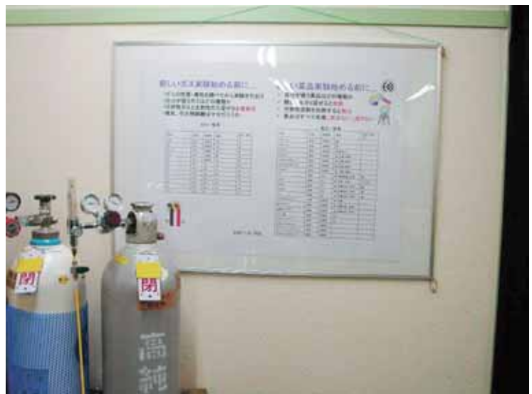
写真2 危険、可燃性がある薬品、ガス及びその組み合わせの掲示
