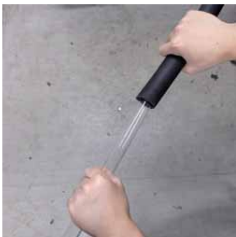
石英管をホースに接続する作業
