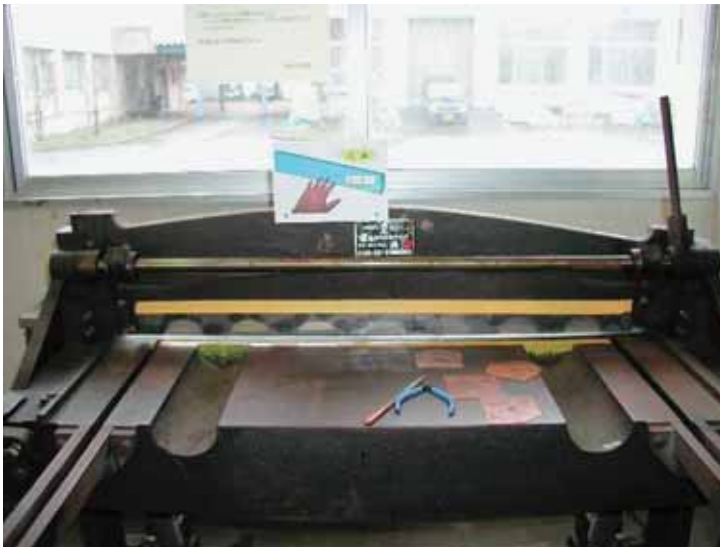
足踏み切断機（改善後）
