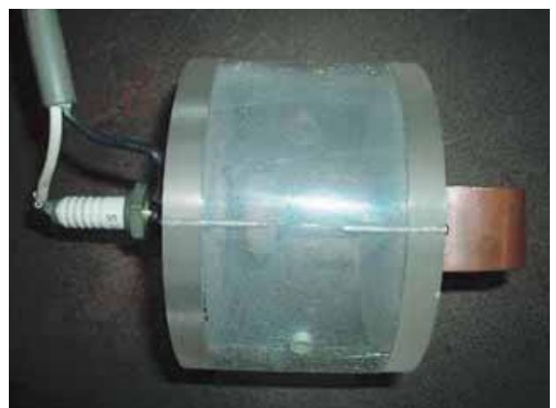
写真4 遠隔操作放電スイッチ
